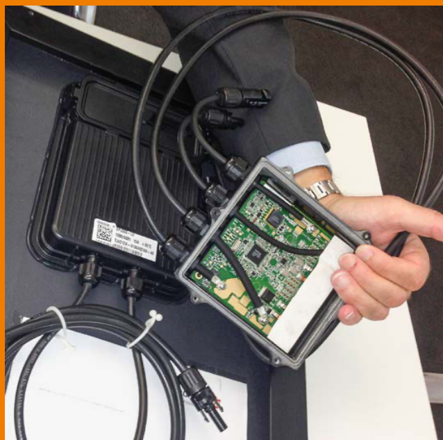
Blick auf die Elektronik eines Leistungsoptimierers von Solaredge.
