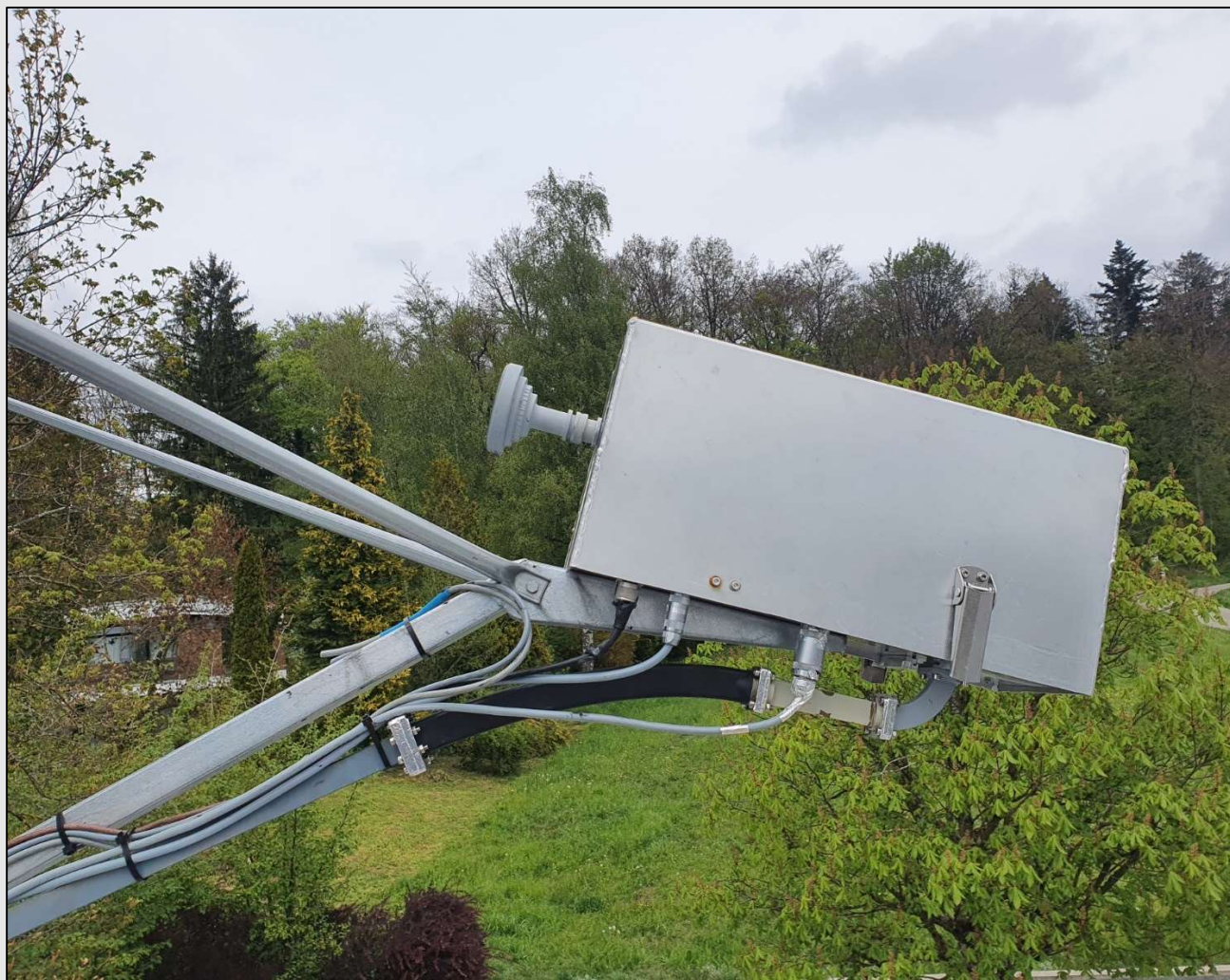
HB9BBD – JN47EI (AG) - 10 GHz Feed im Spiegel-Fokus; Polarizer mit Hohlleiterschalter und Empfangsvorverstärker, 90 Grad drehbar für EME und Tropoverkehr
