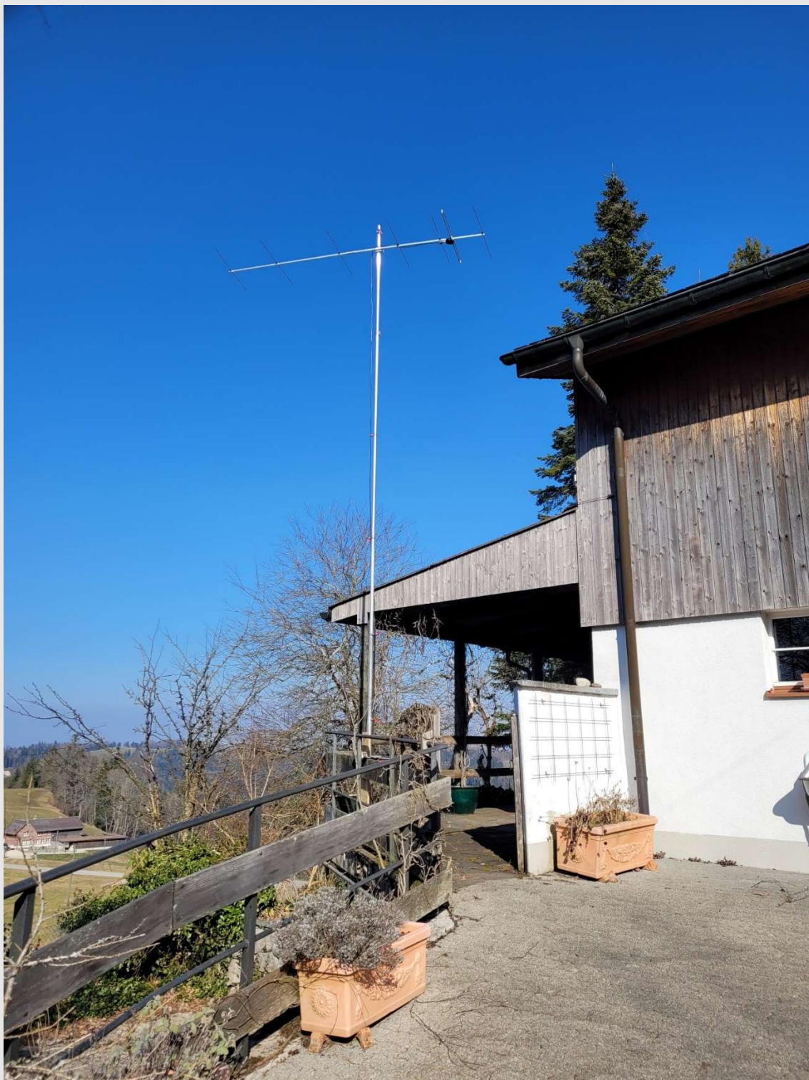
HB9CEJ – QTH Sternenberg (ZH) JN47KJ – 7ele (145 MHz)
