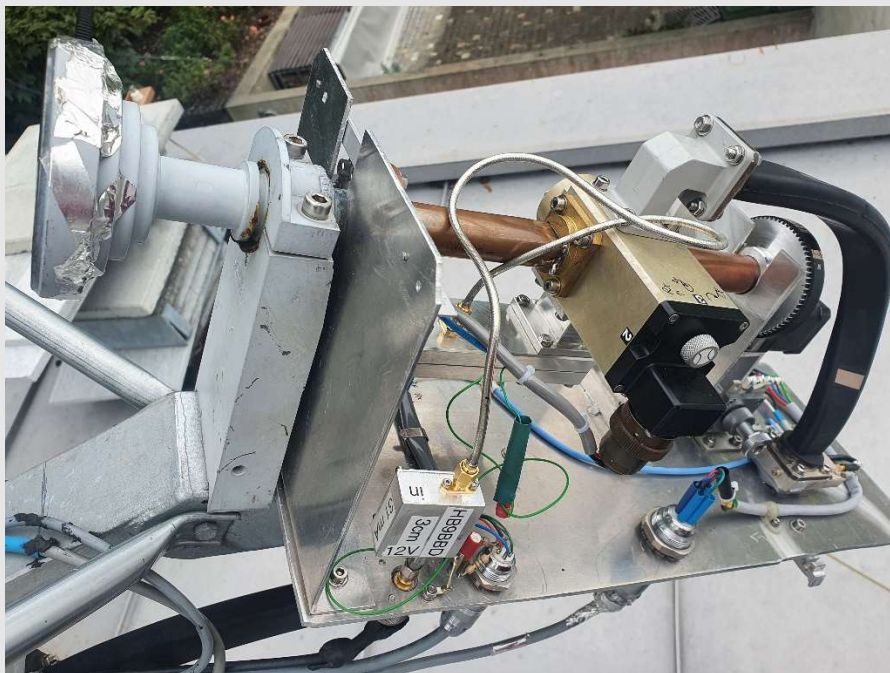
10 GHz Feed im Spiegel-Fokus; Polarizer mit Hohlleiterschalter und Empfangsvorverstärker, 90 Grad drehbar für EME und Tropoverkehr HB9BBD – QTH Oberwil-Lieli (AG), JN47EI
