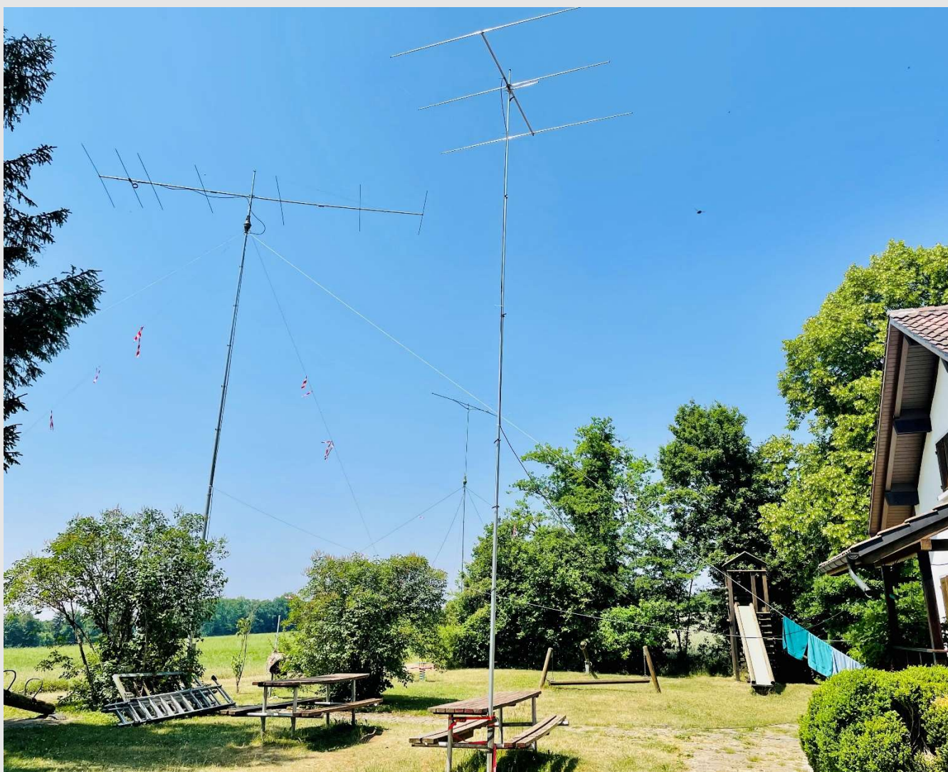
HB9FMT – QTH JN37MI (JU) – 3ele + 5ele + 7ele for 50MHz
