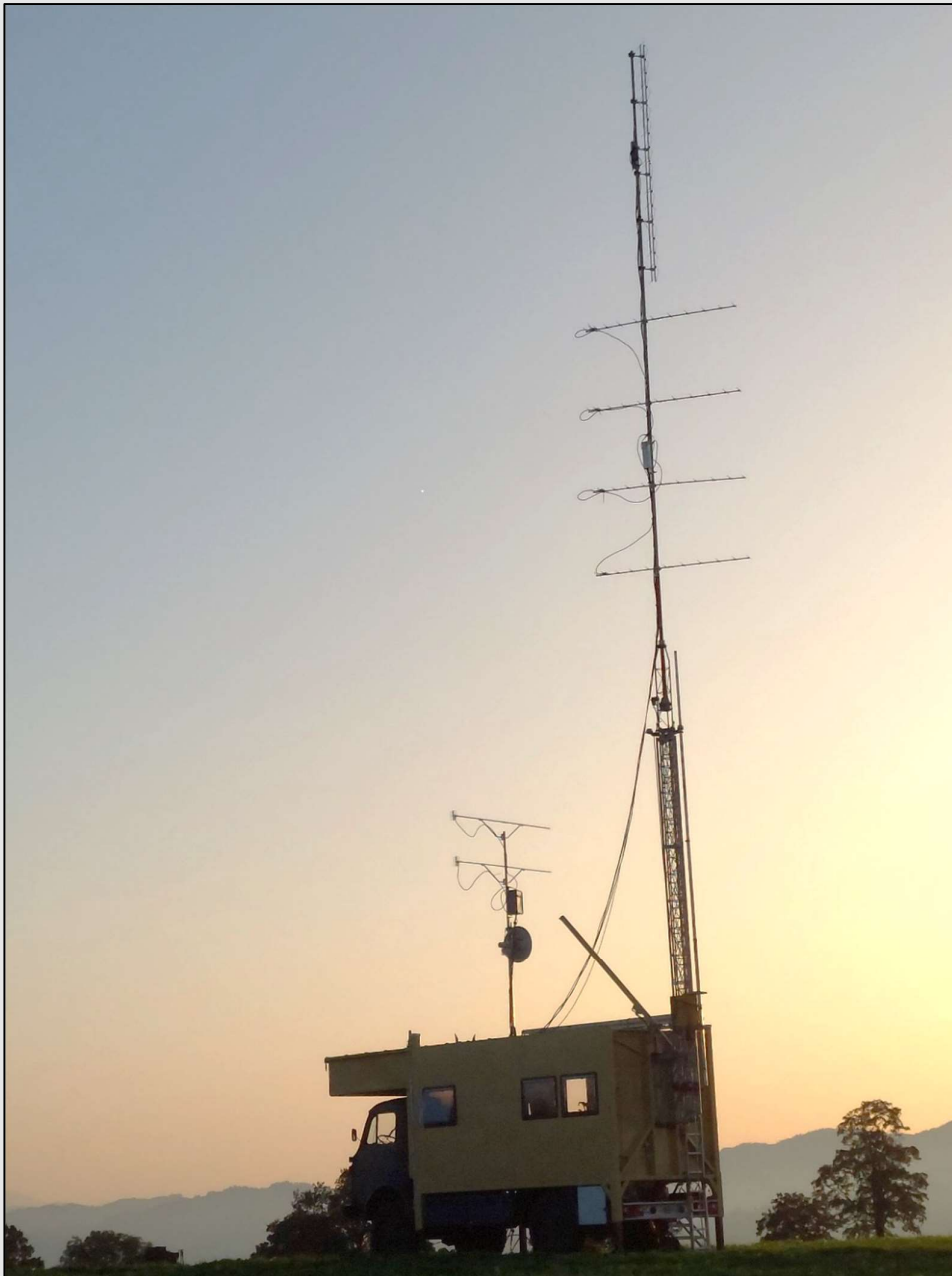
HB9GF – QTH JN47BC (LU) –4x11ele + Quad für 432 MHz 2x44ele für 1296 MHz, 60cm Parabolspiegel für 10368 MHz
