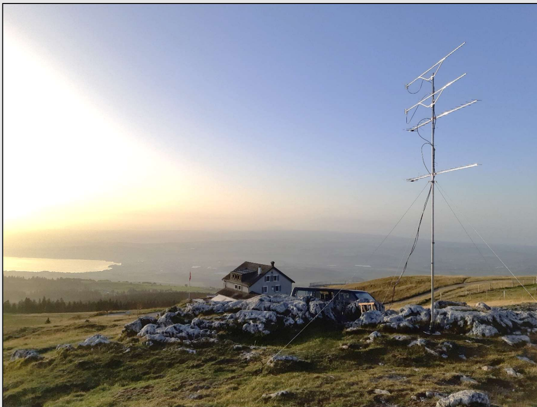
HB9IAB/p – QTH JN36GU (VD) – 2x18ele für 432 MHz, 2x44ele für 1296 MHz
