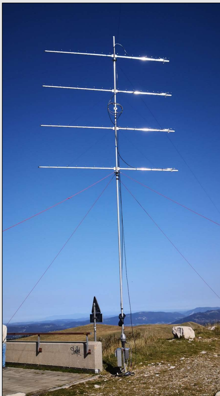
HB9XC – QTH JN37MD (BE) – 4x20ele für 432 MHz
