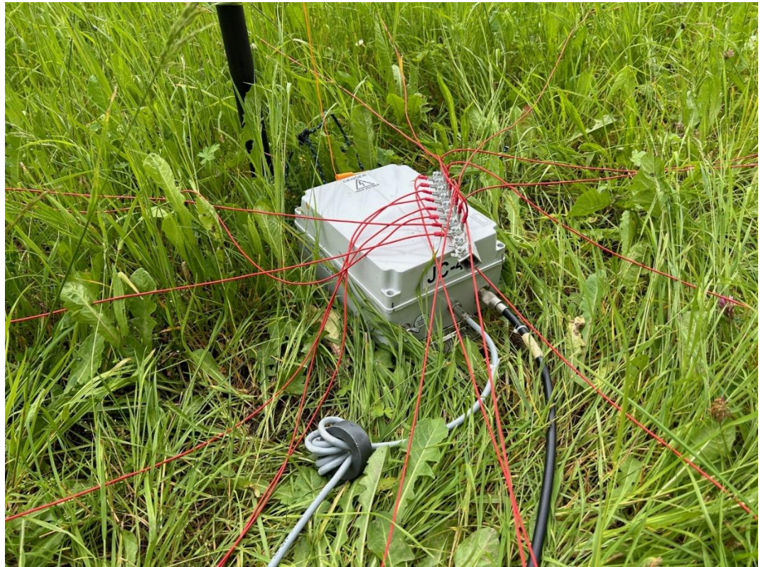
JC-4s Tuner, 16 Radials und Inverted L (oranger Draht)
