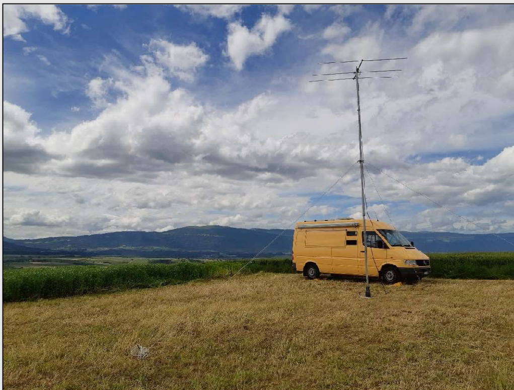
HB9IAB/p – JN36GQ (VD) – 3ele für 50MHz
