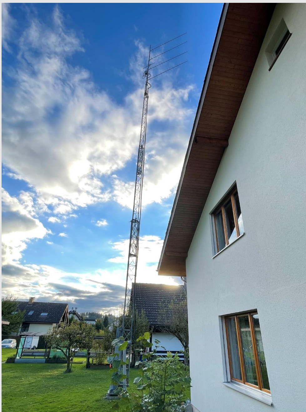
HB9TTY – 4x19ele für 432 MHz – JN37XG (AG)
