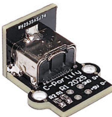
Abb. 2: C-Portify. Links: Ansicht von hinten mit den CC-Widerständen R1 und R2, der USB-C-Buchse und der angelöteten Frontblende. Rechts: C-Portify montiert auf dem PCB eines konvertierten Gerätes.
