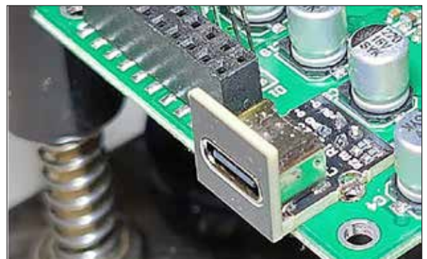
Abb. 2: C-Portify. Links: Ansicht von hinten mit den CC-Widerständen R1 und R2, der USB-C-Buchse und der angelöteten Frontblende. Rechts: C-Portify montiert auf dem PCB eines konvertierten Gerätes.
