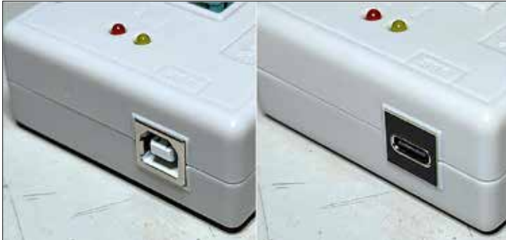
Abb. 1: Gerät mit USB-B-Anschluss vor der Konversion (links) und mit USB-C-Anschluss nach der Konversion.
